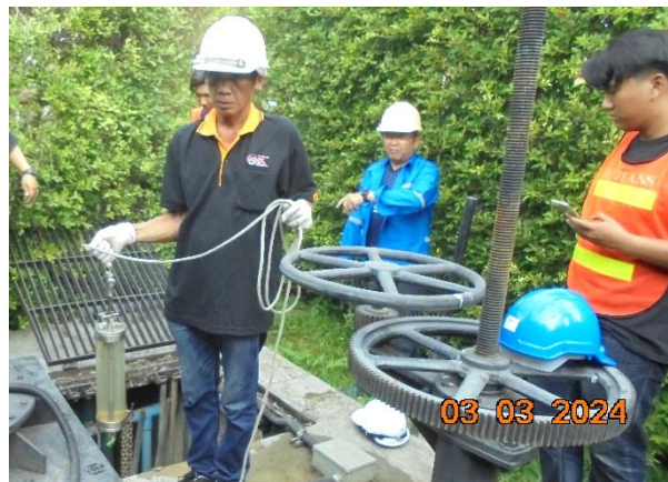
รูปที่ 3-1 การเก็บตัวอย่างน้ำจากระบบบำบัดน้ำเสีย
