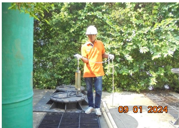
รูปที่ 3-1 การเก็บตัวอย่างน้ำจากระบบบำบัดน้ำเสีย
